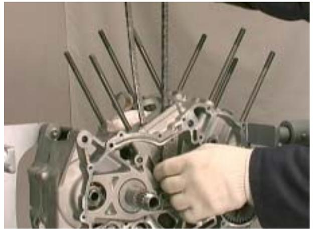
**3.9.4. REAR CYLINDER TIMING UNIT REASSEMBLY**
